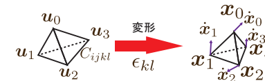
図1 四面体のマテリアル座標系と世界座標系、及びその速度。
